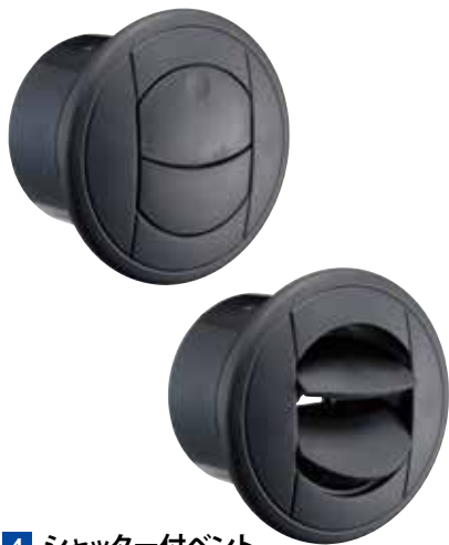
4 シャッター付VENT (税別) 27374 ¥4,860 ¥4,500 ■フランジ寸法：10φcm ■ダクトホースは76mmに対応。 ●空調の噴出し口に最適です。手でシャッターの開き具合を調節でき、前面が360°回転しますので、噴出し方向も調節できます。
