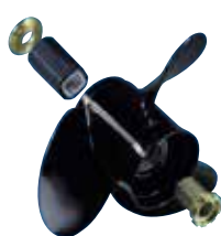
VORTEX (ヴォルテックス) アルミ製プロペラ (セバレットハブ) 分離式のハブを採用しているのでブッシュのみの交換や他社エンジンへの転用が可能です。3ブレード、ラージブレード、4ブレードがあります。
