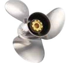
NEW SATURN (ニューサターン) ステンレス製3ブレードプロペラ SATURNに比べ、ハブ径が大きく翼面積が大きい設計で、加速や推進力を重視しています。
