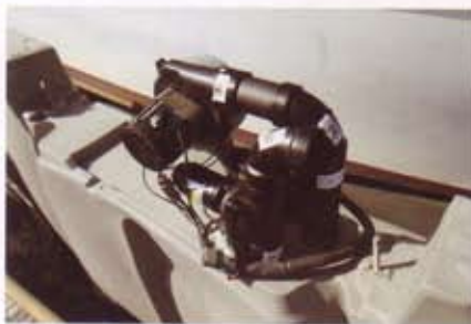
エアーの吸入・排気を行うモーターユニット。タンクモニターステムも搭載する。
