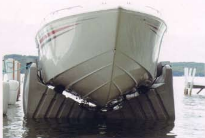
Vリフトにボートを載せ、上架した状態。
