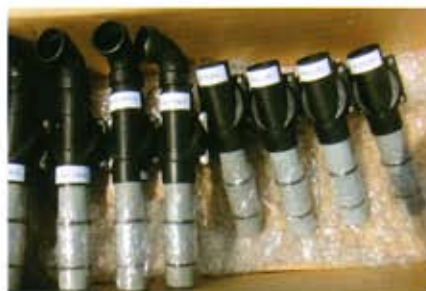
エア注入・排気のパルプユニット。
