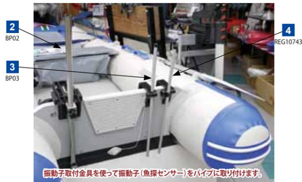
振動子取付金具を使って振動子(魚探センサー)をパイプに取り付けます。
