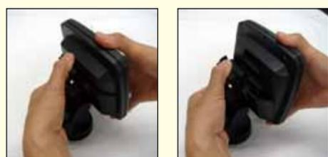
●配線コードを外して背面のつまみを押せば簡単にディスプレイ部分を取り外すことができます。
