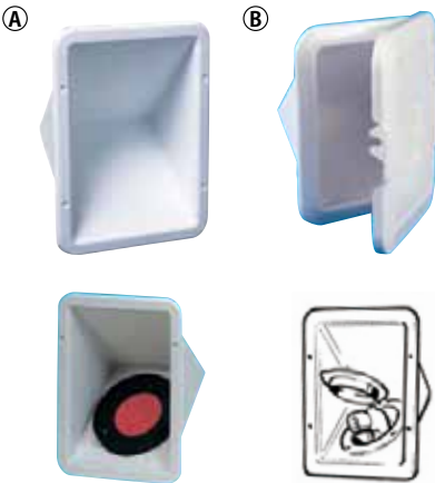
NUOVA RAIDE 3 トラリアングルケース (税別) (A) KZ-44302 ドア無 ￥3,150 ￥3,000 (B) KZ-196414 ドア付 ￥5,460 ￥5,200 ■材質：ABS樹脂 ■フランジ寸法：145×191mm ■内寸法：110×155×80(D)mm ■穴あけサイズ：114×160mm ■②ドアサイズ：165×200mm ●取付けは縦、横どちらでも可能。
