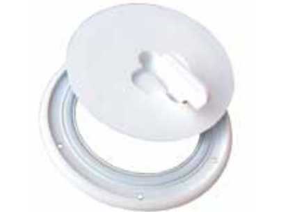
5 クイックリリースプレート (税別) (A) 26327 6インチ ￥3,360 ￥3,200 (B) 26328 8インチ ￥4,725 ￥4,500 ■サイズ： ①フランジ寸法：203mm 開口部：130mm 穴あけ寸法：159mm ②フランジ寸法：254mm 開口部：180mm 穴あけ寸法：210mm ■材質：樹脂製 ●取っ手を90度ひねることによって、簡単に開け閉めができます。 ●Oリングによって、水が浸入しにくい構造です。
