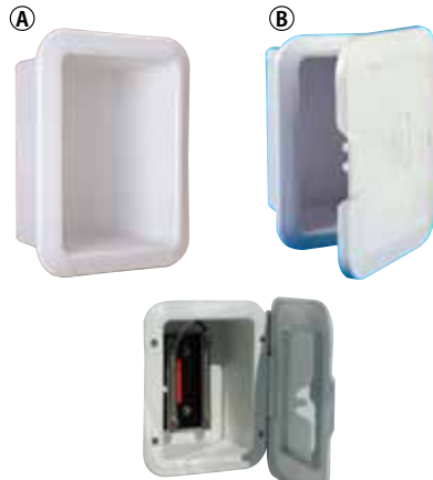
NUOVA RAIDE 4 サイドマウントケース XS (税別) (A) KZ-44301 ドア無 ￥4,410 ￥4,200 (B) KZ-196420 ドア付 ￥4,725 ￥4,500 ■材質：ABS樹脂 ■フランジ寸法：145×191mm ■内寸法：110×155×80(D)mm ■穴あけサイズ：114×160mm ■②ドアサイズ：165×200mm ●取付けは縦、横どちらでも可能。
