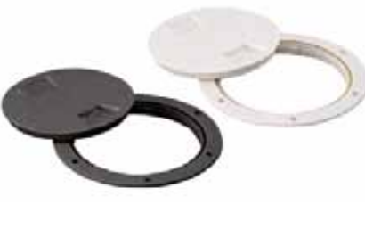
4 インスペクションポート(デッキプレート) (税別) GRP_55725 S ￥1,260 ￥1,200 GRP_55726 M ￥1,785 ￥1,700 GRP_23358 L ￥4,725 ￥4,500 ■カラー：ホワイト、ブラック ■サイズ 寸法 (mm) 外径 開口径 穴開径 S 146 101 114 M 203 152 159 L 254 203 209
