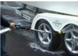
トレーラー足回りフラッシング
