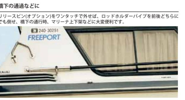
**リリースピン(オフオプション)をワンタッチで外せば、ロッドホルダーパイプを前後どちらにでも倒せ、橋下の通行時、マリーナ上下架などに大変便利です。**
