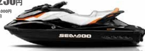
■全長:337cm ■全幅:123cm ■乾燥重量:343kg ■燃料タンク容量:60L
