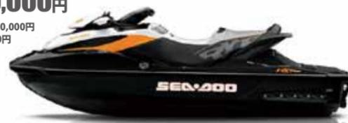
■全長:354cm ■全幅:122cm ■乾燥重量:375kg ■燃料タンク容量:60L
